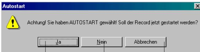
Die Konfiguration wird auf den MSR 12 übertragen. Danach startet die Aufzeichnung.
