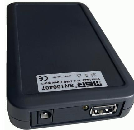
Das MSR Power Pack ist eine autonome Ladestation, die den internen Akku eines MSR Datenloggers während des Betriebs nachladen kann. Dank der Kapazität von 5000 mAh und einem Lade-Intervall von einem Tag können wesentlich längere Messaufgaben realisiert werden. So kann damit z.B. ein MSR165 Datenlogger bis zu 6-mal länger Daten aufzeichnen.
